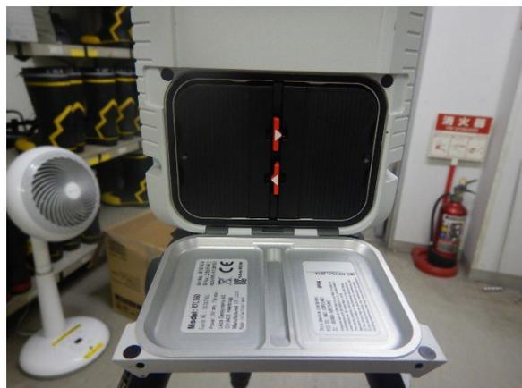
④ スキャナの側面を開き、バッテリーを 2 個「カチッ」と音が鳴るまで押し込み取り付ける。
